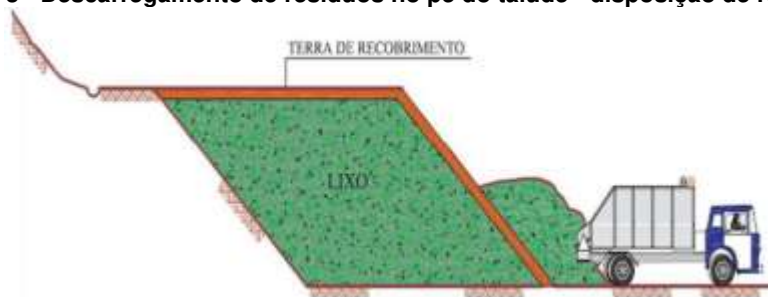
Figura 3 - Descarregamento de resíduos no pé do talude - disposição de resíduos.
