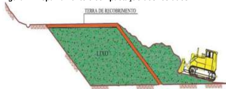
Figura 4 - Espalhamento e compactação dos resíduos.
