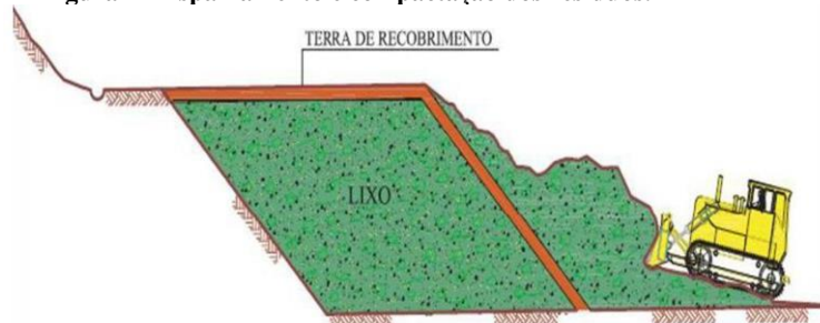
Figura 4 - Espalhamento e compactação dos resíduos.
