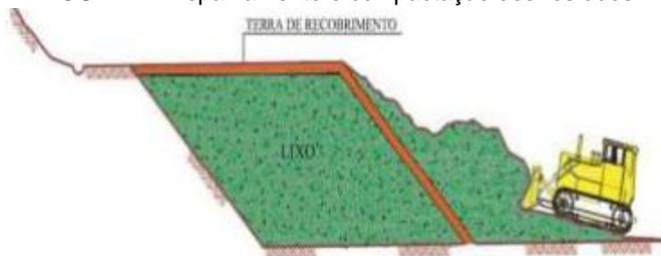
FIGURA 4 - Espalhamento e compactação dos resíduos.
