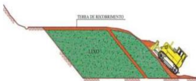
FIGURA 5 - Execução da cobertura diária e operacional dos resíduos.
