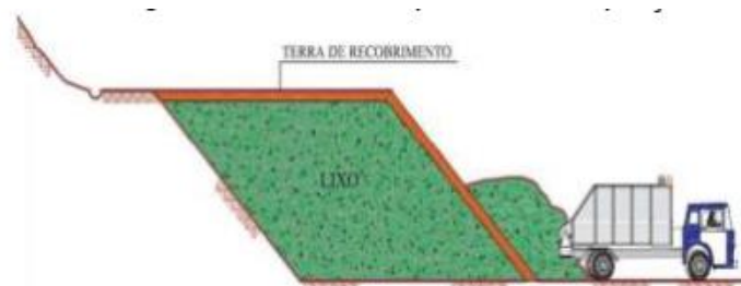
FIGURA 3 - Descarregamento de resíduos no pé do talude.
